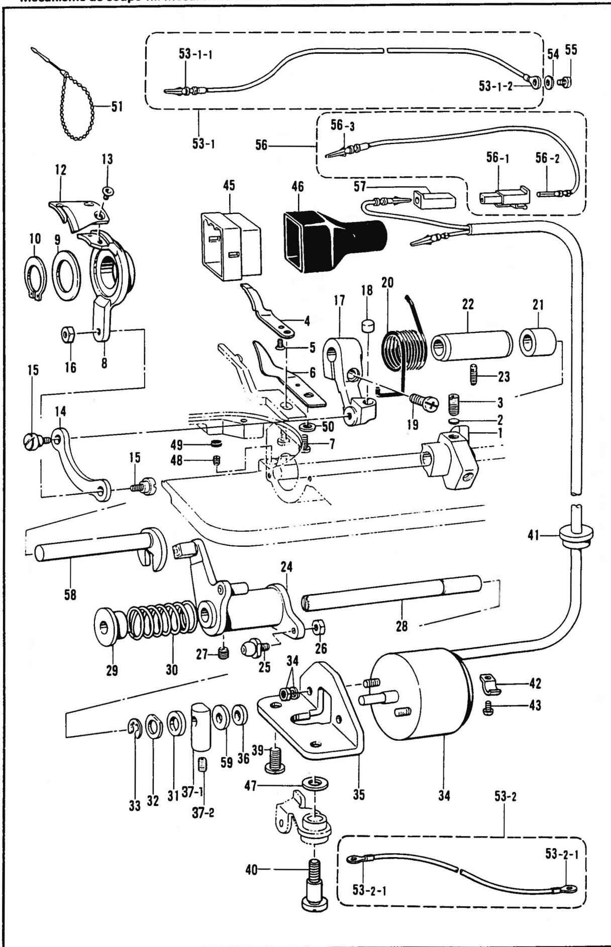
L. 糸切り関係/Thread trimmer mechanism/Fadenabschneidevorrichtung/
