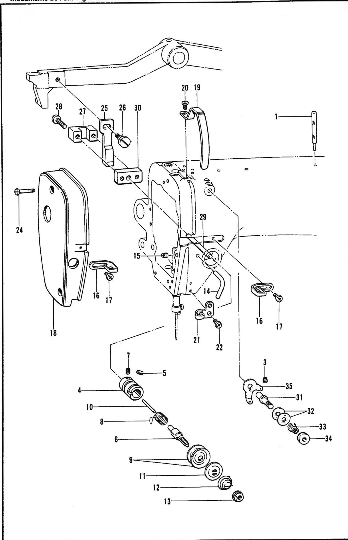
K. 糸通シ関係/Threading mechanism/Fadenführungsvorrichtung/
