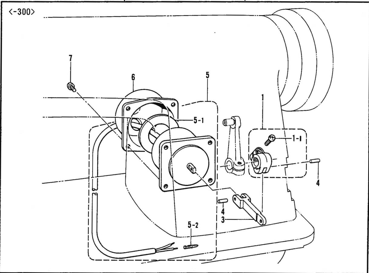
D. 押工関係/Presser foot mechanism/Stoffdrückerfuß/
