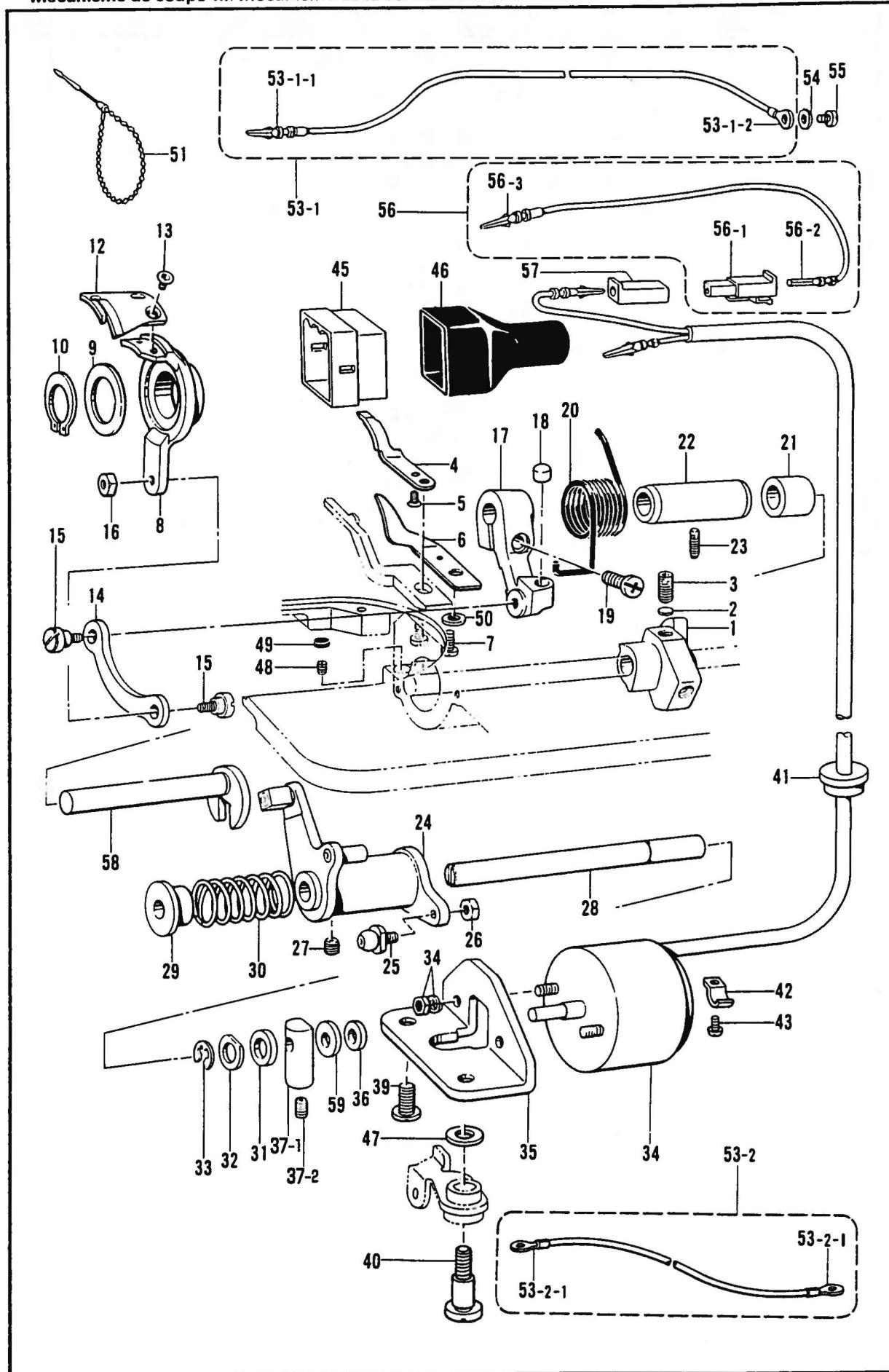
L. 糸切り関係/Thread trimmer mechanism/Fadenabschneidevorrichtung/
