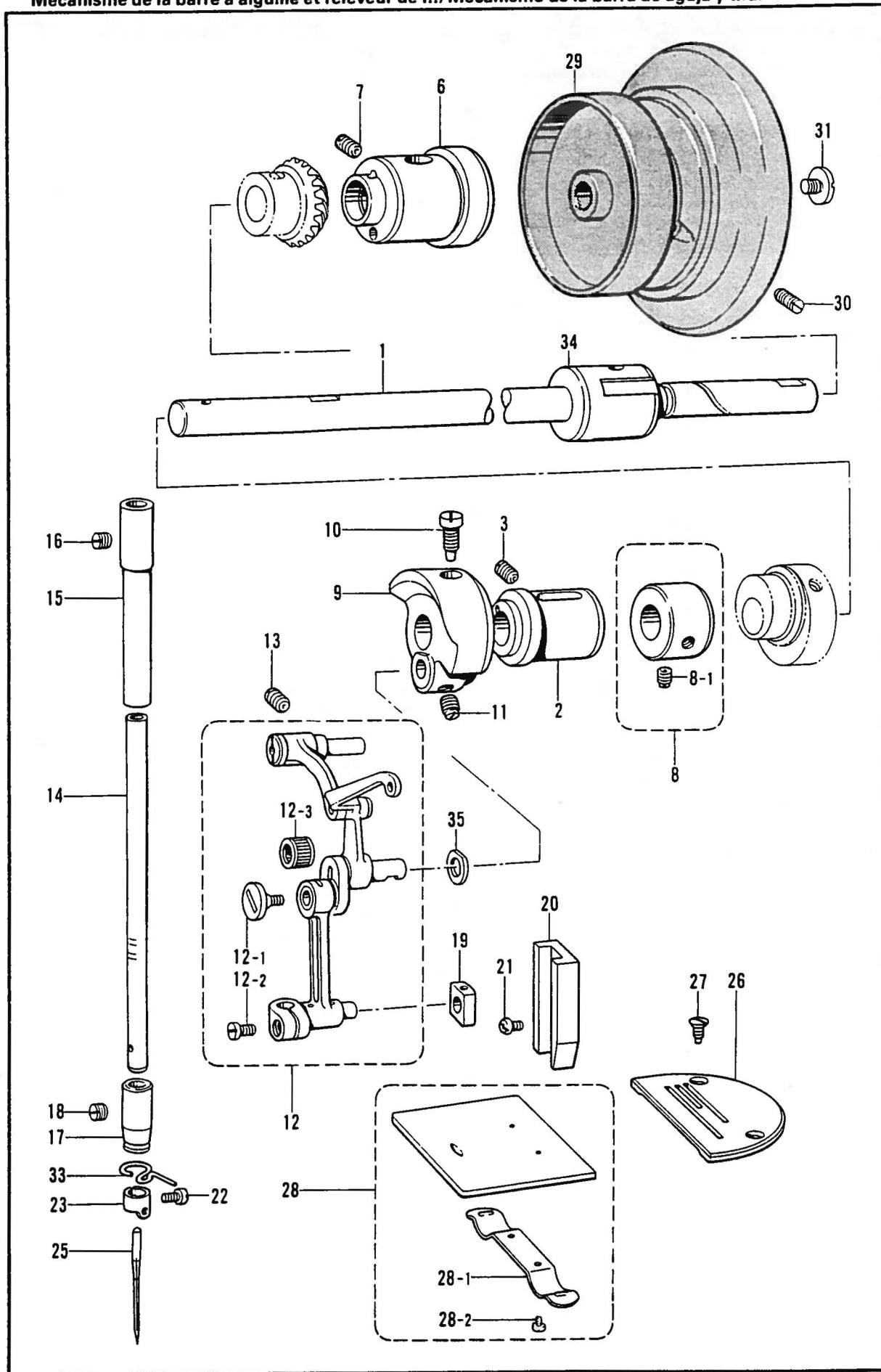
C. 針棒・天ビン関係/Needle bar and thread take-up mechanism/Nadelstange und Fadenabnahmeverrichtung/
