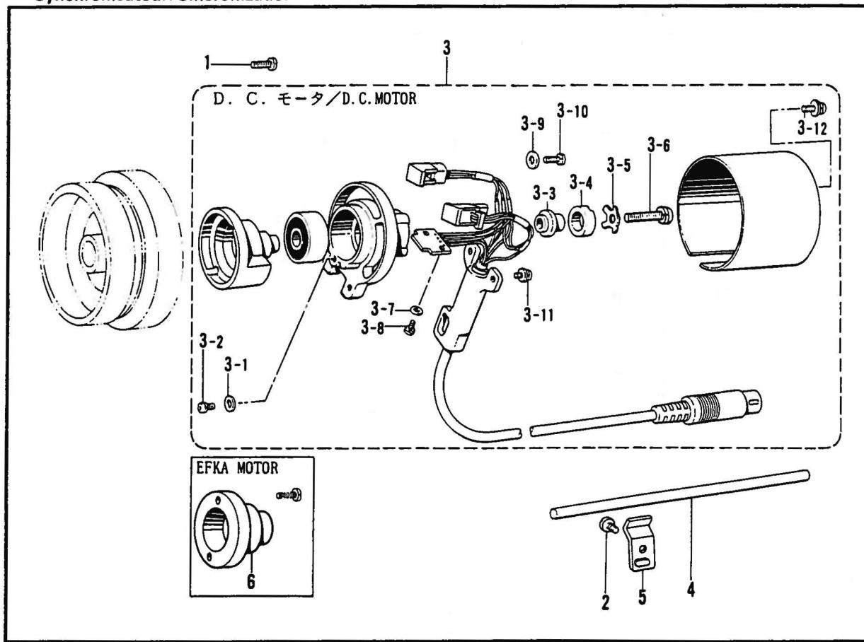
M. 逆転スイッチ関係 / Quick reverse switch mechanism / Umkehrschalter /
